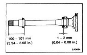
(d) Using a press, press in a new drive shaft side dust cover.
