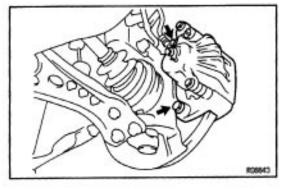
5. INSTALL FRONT DISC AND BRAKE CALIPER
