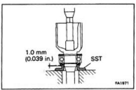
(d) Using SST, an extension bar and press, press in a new dust cover.
