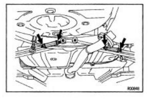
11. TORQUE NO.2 LOWER SUSPENSION ARM LOCK NUTS
