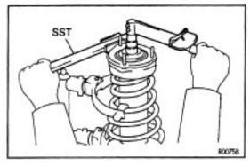
(d) Using SST to hold the upper support, install a new nut. SST 09729–22031
