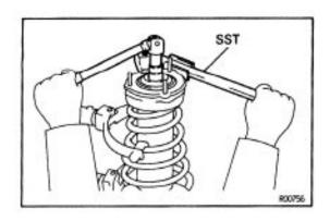
(d) Using SST to hold the upper support, remove the nut. SST 09729–22031
