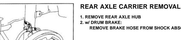
REMOVE BRAKE HOSE FROM SHOCK ABSORBER
