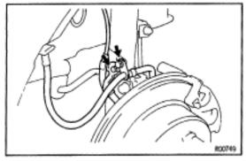
5. DISCONNECT STABILIZER BAR LINK FROM SHOCK ABSORBER
