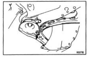
(d) Tighten the bolt on rear side of the lower arm.
