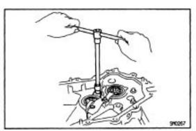
(d) Install the bearing lock plate and torque the bolt.
