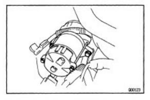
6. DISCONNECT BACK-UP LIGHT SWITCH CONNECTOR
