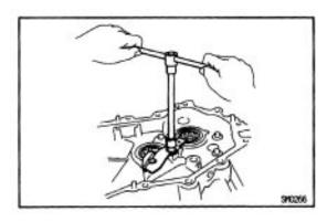
(d) Install the transaxle case receiver and torque the bolt.
