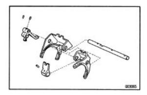
(d) Separate the No.1 shift fork shaft, No.1 shift head, No.1, No.2 shift forks and reverse shift fork.
